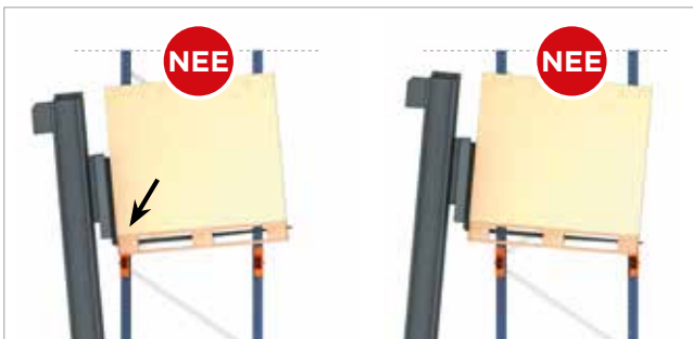
Afbeelding 9. Overbelasting van een ligger doordat de vork van de heftruck de pallet niet horizontaal in- of uitslaat.
